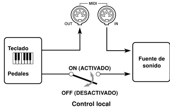
Cuando el control local se encuentra activado (el ajuste normal), cualquier cosa que se ejecute sobre el teclado es emitido por la fuente de sonido interna y generado simultáneamente desde el terminal MIDI OUT. Cuando está desactivado, cualquier cosa que se ejecute sobre el teclado solamente es generada desde el terminal MIDI OUT, sin que se escuche desde la fuente de sonido.
