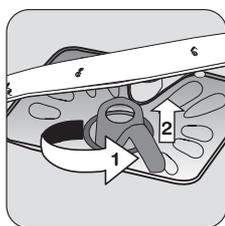
Tournez la poignée d'1/4 de tour dans le sens inverse des aiguilles d'une montre et retirez les filtres **B** et **C**.
