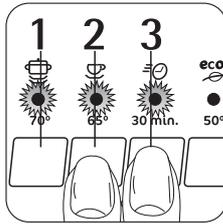
Appuyez simultanément sur les touches multifonctions 2 et 3, et maintenez-les pressées jusqu'à ce que les voyants des touches multifonctions 1, 2 et 3 clignotent.
