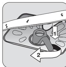
Remettez les filtres en place et bloquez-les en tournant la poignée dans le sens des aiguilles d'une montre.
