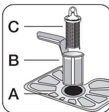
Nettoyez soigneusement les filtres **A**, **B** et **C** sous l'eau courante.
