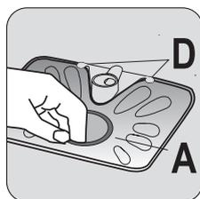
Remettez le filtre plat **A** dans le fond de la cuve et assurez-vous qu'il est correctement placé sous les deux guides **D**.
