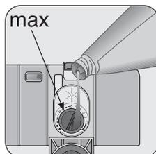
Remplissez de produit de rinçage. Le niveau de remplissage maximal est indiqué par la mention "max".
