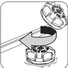
Revissez le bouchon dans le sens des aiguilles d'une montre jusqu'à ce qu'il se bloque en émettant un clic.
