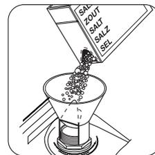
Remplissez complètement le réservoir de sel au moyen de l'entonnoir fourni avec la machine.
