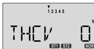
4. Passez maintenant au **point 2** en pressant sur la touche "**à droite**", la petite flèche se déplace au dessus du **chiffre 2**. Ce point est inactif (**Inh**) par défaut. Si vous ne l'activez pas, vous aurez une ligne droite du point 1 au point 3. Sinon, pour régler le point 2, appuyez sur la touche **Data +** ou **Data -**.
