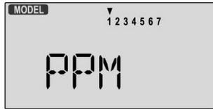
3. **PPM** est le type le plus fréquent appelé FM et qui fonctionne avec tous les récepteurs non PCM. **QPCM** représente une modulation numérique codée et ne fonctionnera qu'avec les récepteurs HITEC QPCM.
