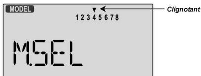
3. **Sélection du type de modèle** : Appuyez sur la touche **Edit haut** jusqu'à ce que le mot **ACGL** apparaisse en clignotant. Pressez une des deux touches "à gauche" ou "à droite" pour faire apparaître le mot **HELI**. Vous devez appuyer simultanément sur les deux touches **Data +** et **Data -** pour enregistrer la configuration après que la radio émette 2 bips sonores. Voilà la procédure pour choisir le type de modèle que vous voulez employer (**ACGL** ou **HELI**).
