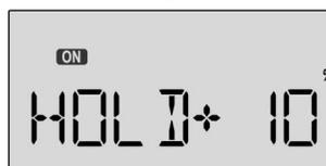
3. Vérifiez que le carburateur revienne à la position désirée en actionnant l'interrupteur gauche **SW1** (**ST3**). Ajustez la valeur si nécessaire. Réglez la valeur du régime moteur de telle sorte que le moteur tienne le ralenti mais sans embrayer.
