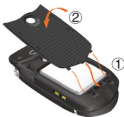
5. Empuje firmemente hacia abajo cada localidad en ambos lados de la tapa de batería, tal como se indican por las flechas de la figura derecha.
