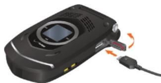
3. Después de que la batería del teléfono se haya cargado por completo, saque el conector del cargador de pared y cierre la caleta del Puerto de Carga/Datos.
