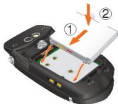
4. Inserte las lengüetas de la tapa de batería en las ranuras ① y oprima la tapa de batería en la dirección indicada por la flecha ②.
