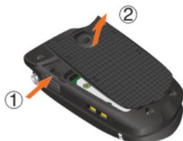
3. Deslice la batería en la ranura alineando los contactos y las lengüetas ①, y oprima hacia abajo la parte ② hasta que escuche un sonido "clic".
