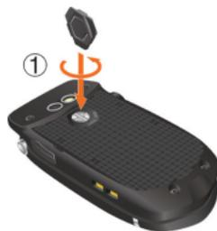
2. Inserte su dedo en la ranura ① y jale hacia arriba la tapa de batería en la dirección indicada por la flecha ②.
