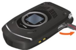
2. Inserte el enchufe de energía eléctrica del cargador de pared en una tomacorriente, y conecte el conector del cargador de pared al puerto de Carga/Datos.
