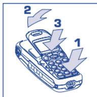
Вставить нижнюю часть лицевой панели в аппарат, а потом защелкнуть верхнюю часть лицевой панели в корпус аппарата
