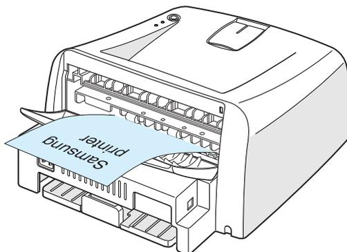
Si se imprime desde la bandeja manual en la bandeja posterior de salida, se consigue el **recorrido recto del papel**. La apertura de la bandeja posterior de salida puede mejorar la calidad de la impresión cuando se utilizan los siguientes materiales de impresión:
