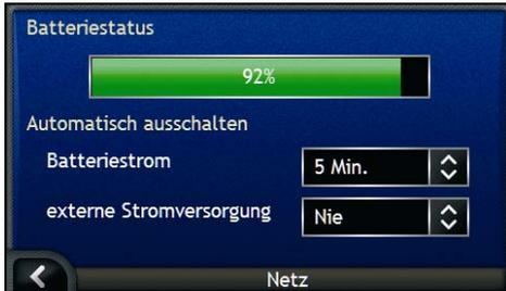
Der Balken **Batteriestatus** zeigt den Prozentsatz der Ladung, die noch in der iCN Batterie vorhanden ist; das Wort **Ladevorgang** wird anzeigen, wenn die Batterie von einer externen Stromquelle auflädt. Um Die Batterie aufzuladen, siehe „Interne Batterie“ auf Seite 16.
