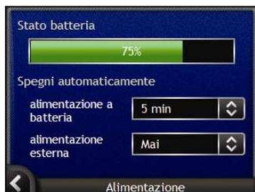
La barra **Stato batteria** mostra la percentuale di carica rimasta nella batteria del Navman; quando la batteria viene caricata da una fonte di alimentazione esterna, apparirà la frase **In carica**. Per caricare la batteria, vedere "Batteria interna" a pagina 16.
