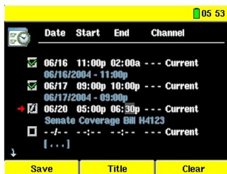
*Scheduler nach Abschluss der Einstellungen. "--- Current" bedeutet, dass der AV400 das "aktuelle" Videosignal aufnehmen wird (keine Kanalschaltung). Dies kommt dann zum Tragen, wenn die aufsteckbare Infrarot-Vorrichtung nicht verwendet wird.*
