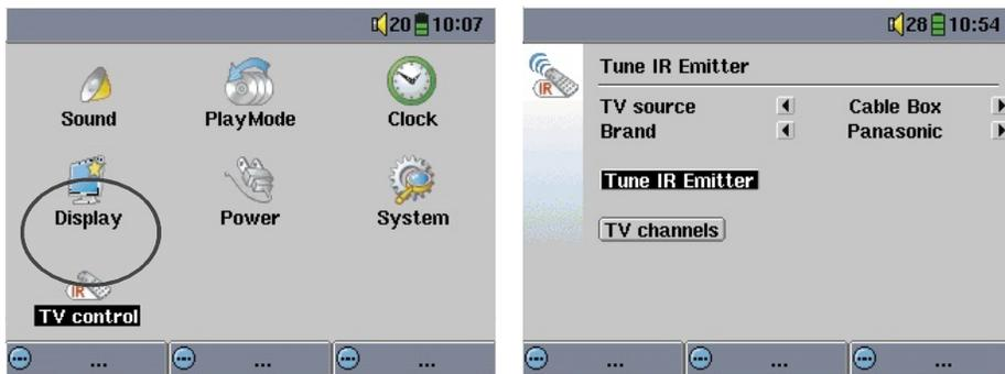
1. Wählen Sie den Typ des Geräts, mit dem I/R-Sender verbunden ist. Zur Auswahl stehen **VCR** (Videokassettenrekorder), **Cable Box** (Kabel-TV-Box) und **Satellite Receiver** (Satellitenempfänger).
