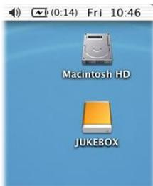
Es ist ein Betriebssystem ab der Version 9.2 erforderlich. Nach der Aktualisierung des OS sind keine speziellen Treiber oder Extensions erforderlich. Den AV400 einfach wie oben beschrieben an den Macintosh anschließen, das Gerät wird automatisch binnen weniger Sekunden als Massenspeichereinheit (Festplatte) erkannt und ist auf dem Desktop gemountet. Das Laufwerk namens JUKEBOX lässt sich nun wie jede herkömmliche externe Festplatte handhaben.
