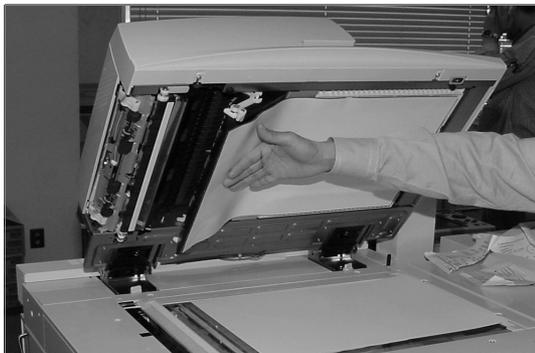
5. Limpe o vidro espelhado, a tira de metal, **os dois** lados da tira de plástico branca e os rolos usando um pano macio umedecido com água para remover qualquer sujeira e, em seguida, limpe-os com um pano macio e seco.
