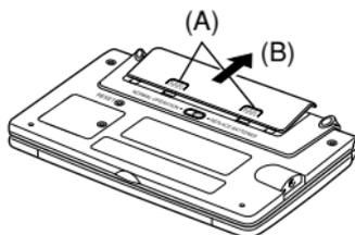
4. Estrarre entrambe le pile vecchie e sostituirle con altre nuove.
