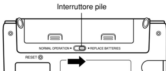
3. Premendo nei punti contrassegnati con (A) nell'illustrazione, far scorrere il coperchio del comparto pile nella direzione (B) per rimuoverlo.
