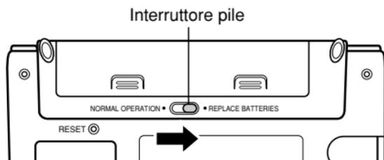
2. Premendo nei punti contrassegnati con (A) nell'illustrazione, far scorrere il coperchio del comparto pile nella direzione (B) per rimuoverlo.
