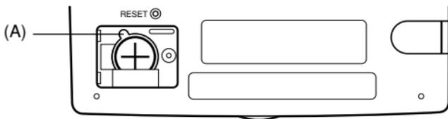
4. Inserire una pila nuova nel comparto, accertandosi che il suo lato positivo sia rivolto verso l'alto (in modo che sia visibile).
