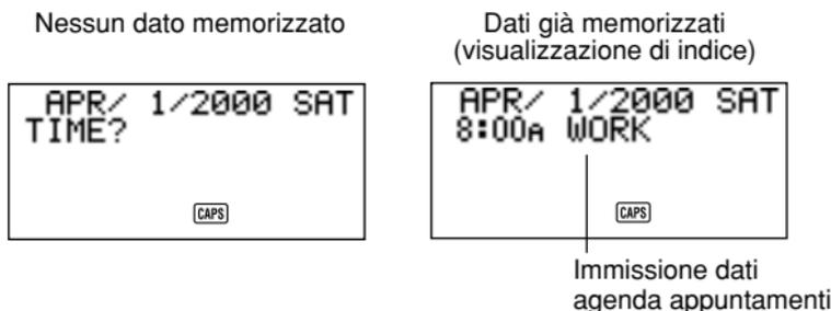
Nel caso della visualizzazione a destra (dati già memorizzati), è possibile visualizzare la domanda "TIME?" (orario?) premendo **CLEAR**.
