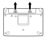
4 Entfernen Sie beide alten Batterien, und setzen Sie die neuen Batterien ein.
