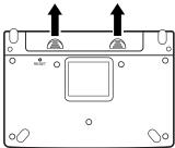
2 Setzen Sie die beiden Batterien ein, und bringen Sie danach den Batteriefachdeckel wieder an.
