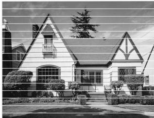
In caso di ostruzione di un ugello della testina di stampa, la prova di stampa appare in questo modo.
