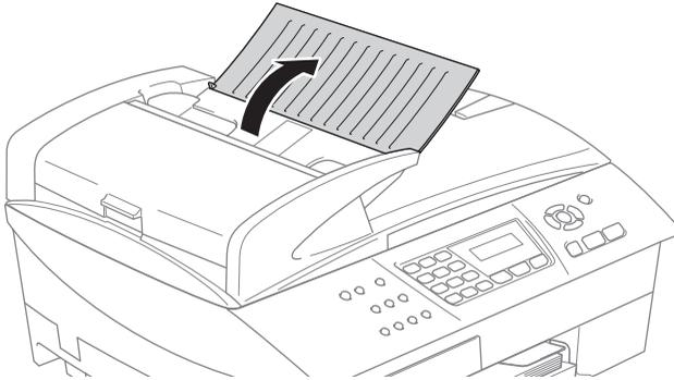
**2** Ventilez les pages et disposez-les de manière décalée formant un angle. Placez les documents **face imprimée tournée vers le haut, en engageant d'abord le bord supérieur** dans le chargeur de document automatique (ADF) jusqu'à ce qu'ils touchent le rouleau d'alimentation.
