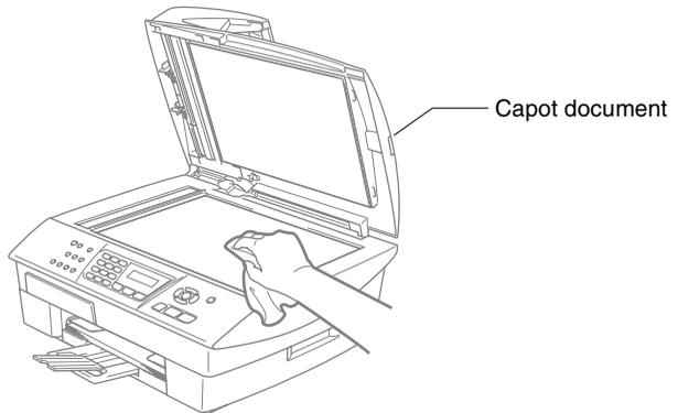
Nettoyez la barre blanche et la bande de verre sous le film avec de l'alcool isopropyl sur un chiffon non pelucheux.
