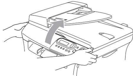
Aún puede utilizar el equipo incluso si la cubierta del escáner está levantada. Puede devolver la cubierta del escáner a su posición inicial pulsándola hacia abajo con las dos manos.
